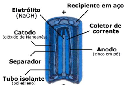
A pilha alcalina é composta por uma mistura eletrolítica: pasta básica de NaOH (hidróxido de sódio - bom condutor eletrolítico). Já a pilha seca comum contém cloreto de amônio NH<sub>4</sub>Cl (sal ácido) e recebe a classificação de ácida.
