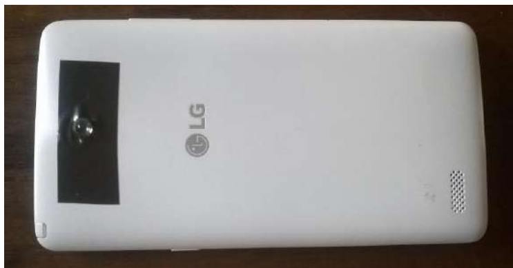
Figura 24: Microscópio alternativo usando um celular com câmara e lente de leitor de CD.
