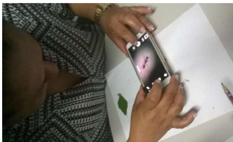
Figura 26: Professora usando o microscópio feito com celular e leitor de CD.
