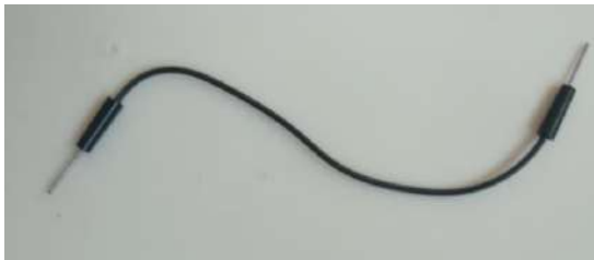
Figura 20a: Cabo jumper. Fonte: Próprio autor.
