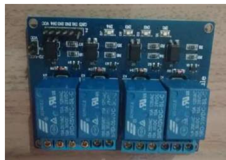
Figura 18b – Modulo rele. Fonte: Próprio autor.
