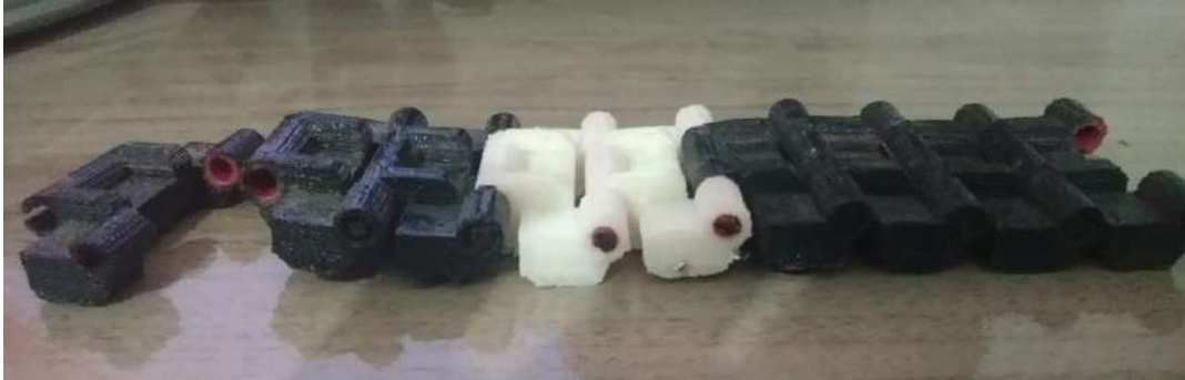
Figura 23: Esteiras do tipo lagarta feitas em impressora 3D. Fonte: Próprio Autor.
