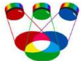
Figura 51 - Esquema da soma das cores primárias Fonte: Newton, Helou e Gualter (2016).
