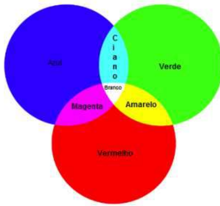
Figura 20 - Resultado da adição de cores primárias. Fonte: Pires (2017).
