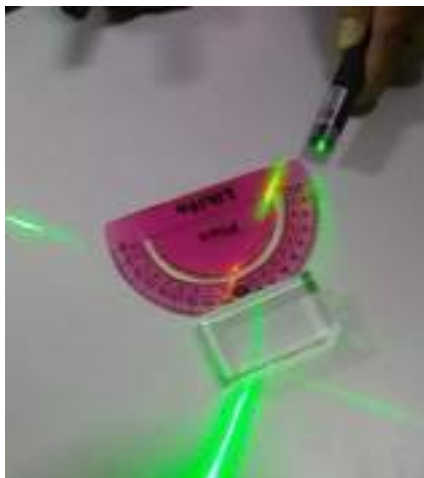
Figura 50- Refração dupla em uma lâmina de faces paralelas. Fonte: A autora, 2019.
