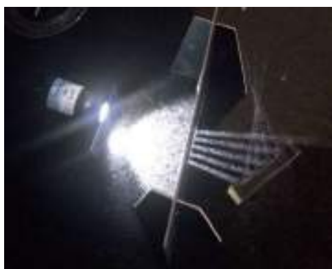
Figura 58 - Projeção de um feixe de luz no espelho côncavo
