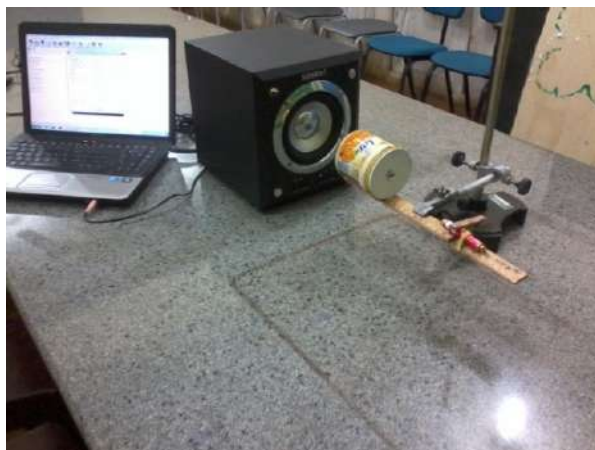
Figura 19: Aparato experimental montado para a realização do teste de eficiência para baixas frequências, entre 1Hz a 200 Hz.
