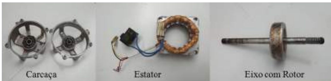
Figura 35 - Partes do motor de ventilador
