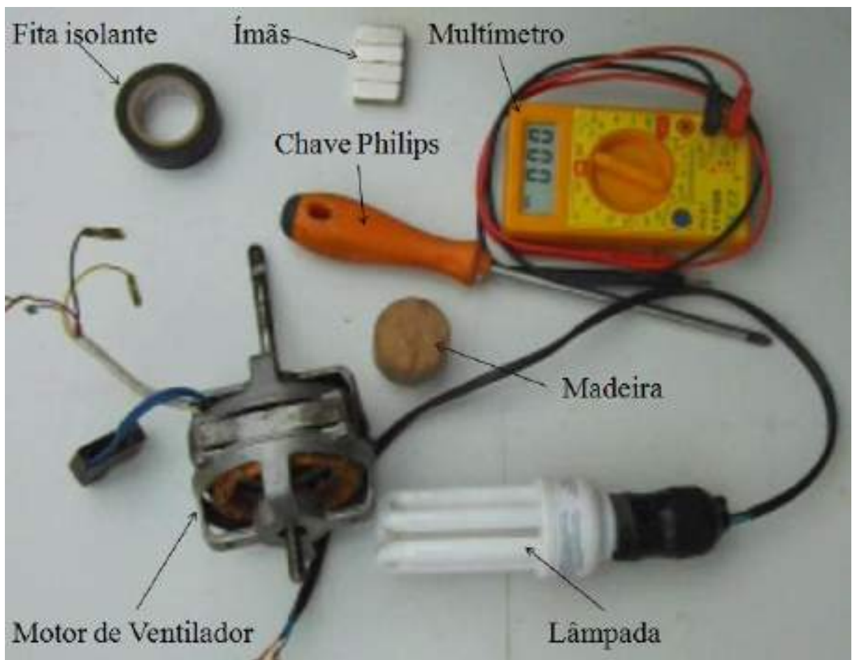
Figura 30 - Materiais para construção e teste do gerador
