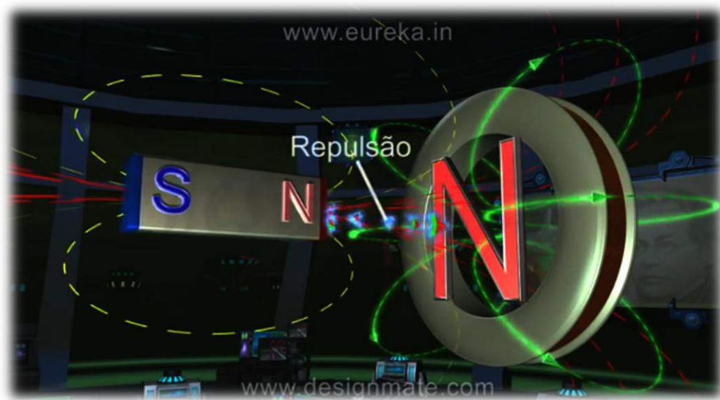
Figura 22 – Cena de vídeo disponível no serviço YouTube onde a lei de Lenz é explicada. Surge uma força de repulsão entre o polo do ímã que se aproxima e a face da bobina, exatamente como se polos iguais de dois ímãs fossem obrigados a se aproximar.
