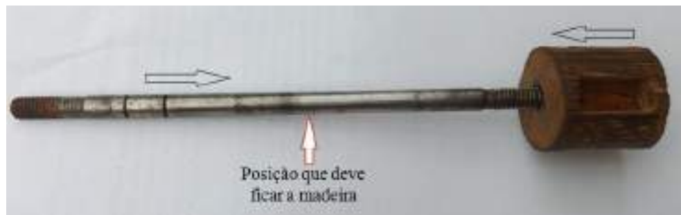
Figura 36 - Esquema de montagem do rotor
