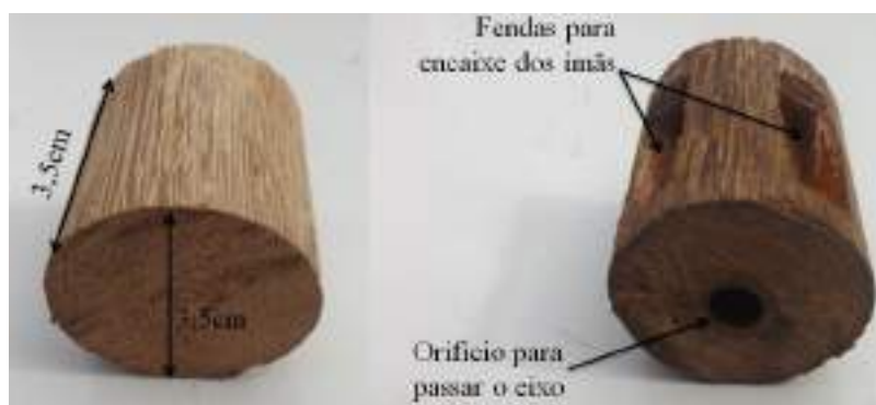
Figura 33 - Madeira que servirá de suporte aos ímãs do rotor
