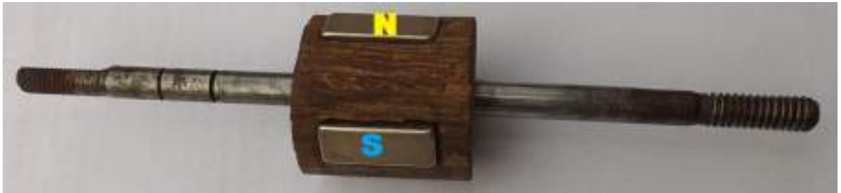
Figura 37 - Ímãs intercalados na madeira
