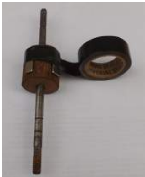
Figura 38 - Fixando os ímãs na madeira.
