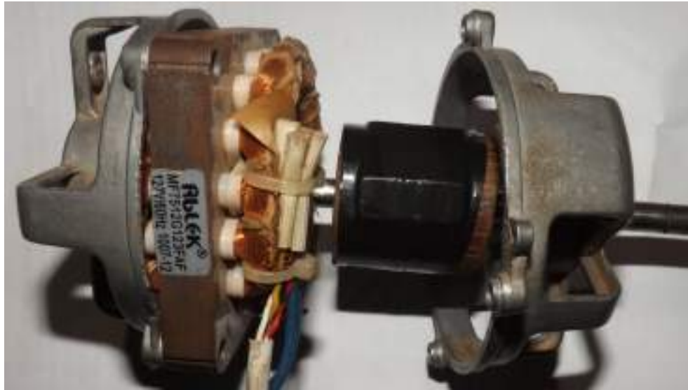
Figura 39 - Colocando o rotor no estator.
