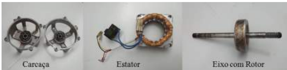
Figura 35 - Partes do motor de ventilador
