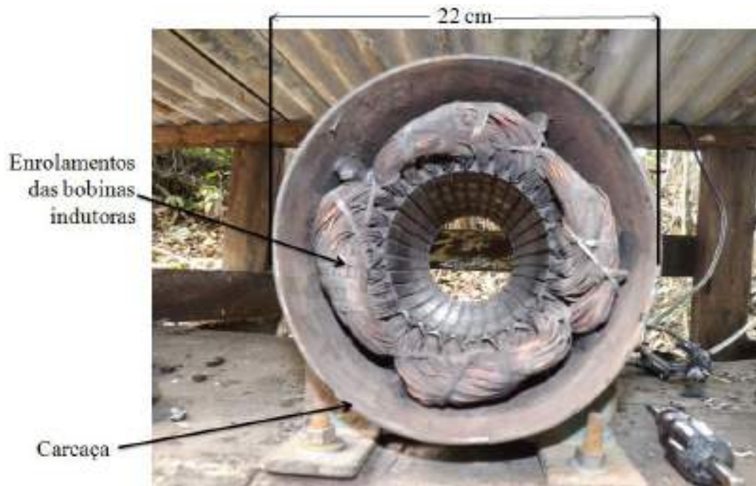
Figura 27 – Vista interna do dispositivo gerador. O estator, ou seja, a parte imóvel é mostrada em destaque
