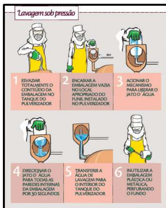
Figura 89 - Lavagem sob pressão. Fonte: INPEV, 2020.
